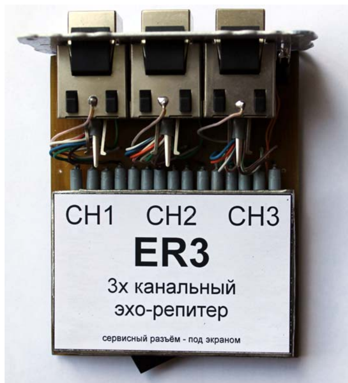
Эхо-репитер со снятым корпусом-экраном
