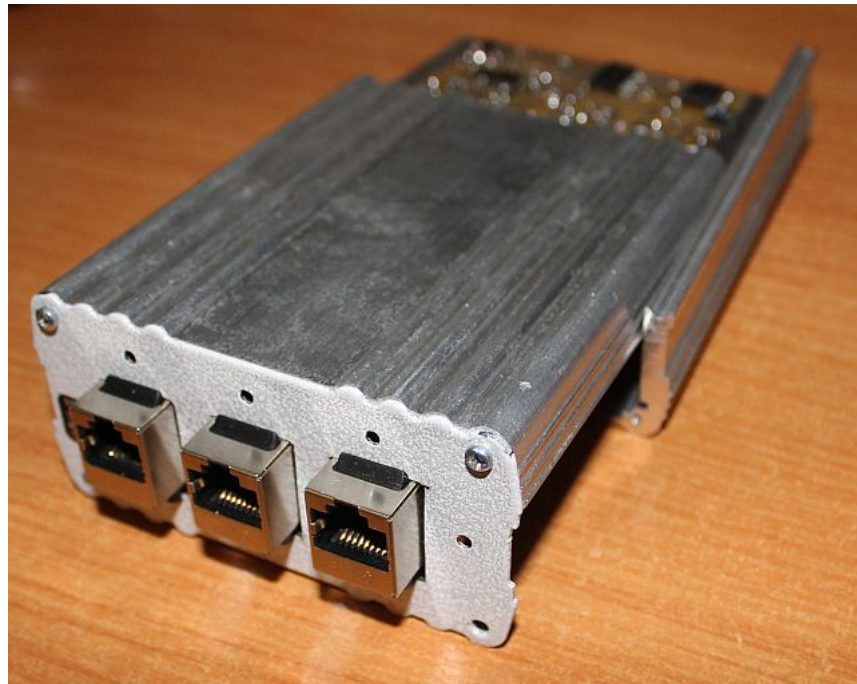
Эхо-репитер с открытым корпусом: на передней панели находятся разъёмы подключения к трансиверам и индикаторные светодиоды SQL над ними; светодиод VD10 справа
